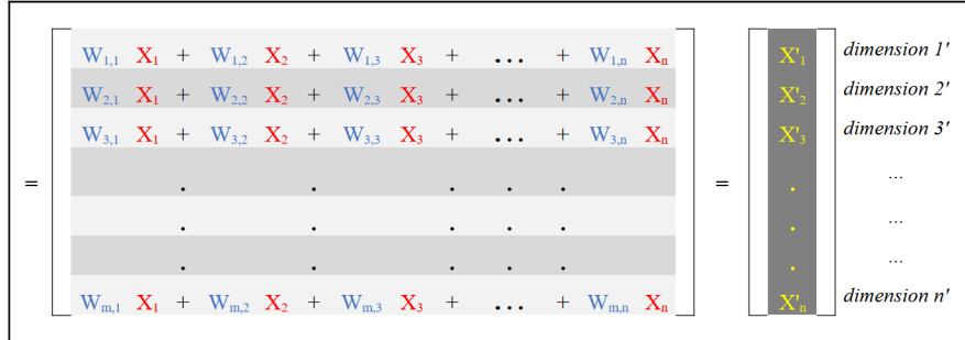
Schéma 2 : résultante du produit matriciel des poids neuronaux à la sortie d'une couche.
